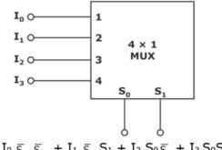
$Z = I_0 \ \overline{S}_{_0} \ \overline{S}_{_1} \ + I_1 \ \overline{S}_{_0} \ S_1 \ + \ I_2 \ S_0 \overline{S}_{_1} \ + \ I_3 \ S_0 S_1$
