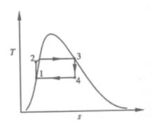
$$\eta_r = \frac{(h_3 - h_4) - (h_2 - h_1)}{h_3 - h_2}$$
