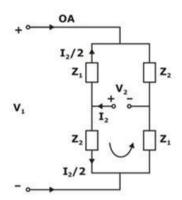
$$-V_2^{} + \frac{I_2^{}}{2}\,Z_2^{} + \frac{I_2^{}}{2}\,Z_1^{} = 0$$
