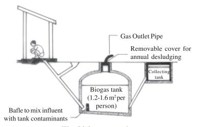
Fig. 30.2: Biogas Plant
